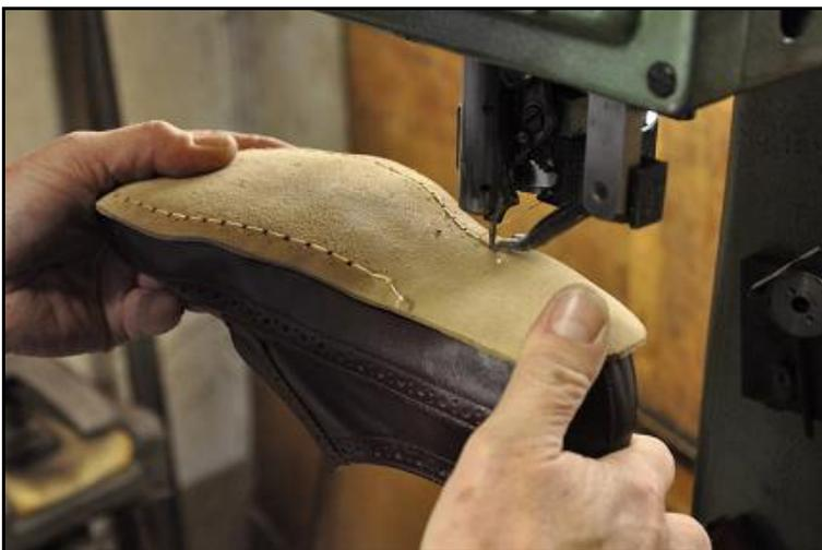
**Schuhe der Machart „Blakebest“** sind ebenfalls genäht. Zuerst werden Rahmen, Schaft und Brandsohle miteinander verbunden. Danach werden Laufsohle und Rahmen mittels einer Doppelnaht vernäht.
